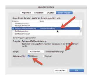
Jetzt speichert FileMaker bei jeder Größenänderung dieser Datei die Werte in unseren Feldern. Damit das funktioniert, müssen Sie zum Schluss noch das Startscript "SYSTEM" einbinden. Unter dem Menüpunkt **Ablage** → **Dateioptionen** → **Script-Trigger** weisen Sie dem Ereignis "Beim ersten Fenster öffnen" das Script "SYSTEM" zu. An dieser Stelle können Sie auch die Werkzeugleisten dauerhaft ausschalten.
